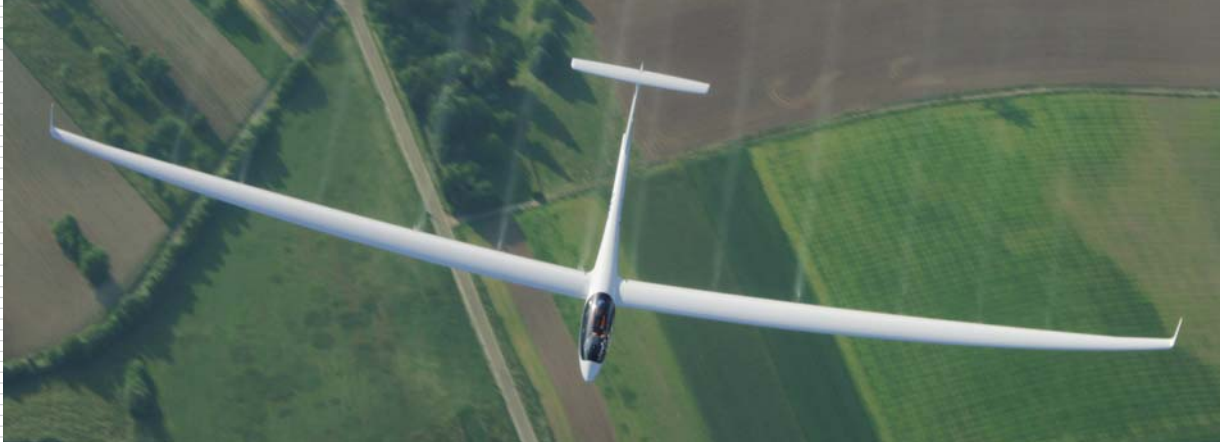
Mit zehn bzw. zwölf elektrisch angesteuerten Flügeltanks ist es möglich, bei jeder Wetterlage mit einer optimalen Flächenbelastung zu fliegen.
